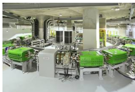
シンクロトロンで、炭素の原子核を光速の約70%まで加速させ、高いエネルギーを持ったビームを作り出す。
