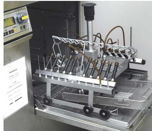
(管腔構造を有する器械に使用する洗浄用ラックの一例)
